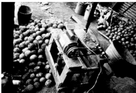
**Fig. 5.** Taladro movido por motor eléctrico para barrenar el fruto y extraer la pulpa (fotografía del autor).
